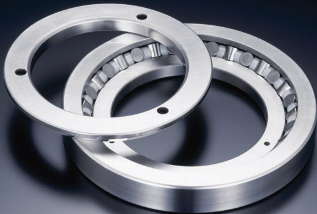
組合せ円すいころ軸受と同等の機能を、軸受1個分のサイズで発揮できるようにした軸受です。分割した軌道輪と一体形の軌道輪の間に、転動体(円すいころ)の向きを交互に変えて配列しています。
